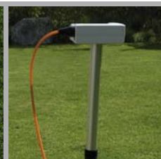
Измерительная штанга и корпус с электронным оборудованием
