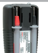
Halterung der Messspitzen
