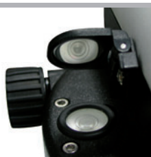
Klappspiegel zum einfachen Ausrichten
