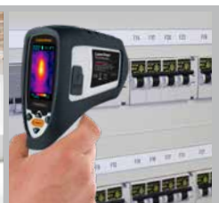
Analisi di fusibili sovraccarichi
